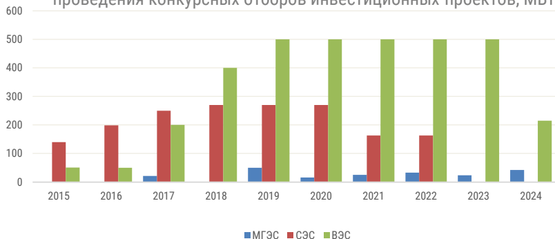
Целевые показатели объемов ввода объектов ВИЭ для проведения конкурсных отборов инвестиционных проектов, МВт
