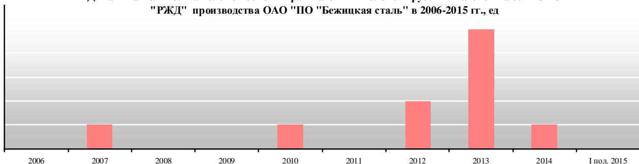
Динамика количества изломов боковых рам вагонных тележек грузовых вагонов на сети ОАО "РЖД" производства ОАО "ПО "Бежицкая сталь" в 2006-2015 гг., ед
