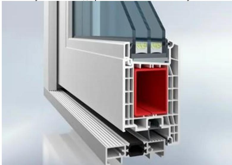
За жесткость и взломостойкость отвечает более мощное замкнутое армирование 50x40x2 мм, а за теплосбережение – более теплое пятикамерное исполнение. В комплектацию дверей системы Arctica входят также б-камерные коробка и импост, штульп, теплый порог с термовставкой и профиль уплотнителя порога. Удаление оси фурнитурного паза новой створки 13 мм. Для монтажа входных групп имеется весь необходимый комплект прямых и угловых соединителей, включая 2 варианта статических элементов.
