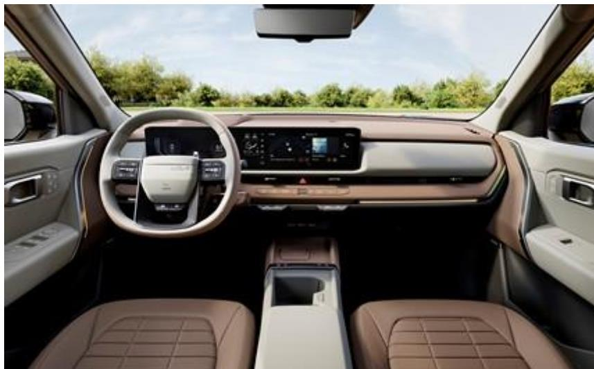
Внутри автомобиль напоминает современные электрокары Kia. На панели два больших экрана (по 12,3 дюйма каждый) и отдельный блок для управления климатом. Вентиляционные решетки узкие, а физических кнопок на центральной консоли немного. Мультимедийная система может обновляться "по воздуху" и работает с голосовым помощником.
