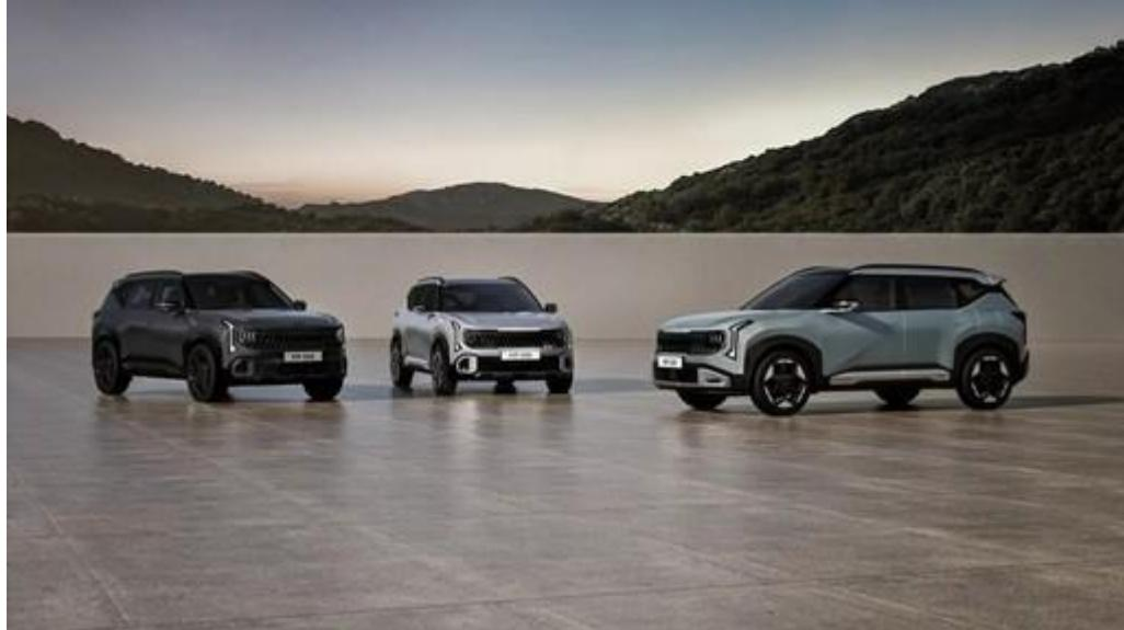
В основе Seltos лежит модернизированная платформа K3, которая также используется в Kia Niro и K4, а также в Hyundai Kona и Elantra. Заявлено об улучшении жесткости кузова, шумоизоляции и баланса шасси. Длина нового Kia Seltos составляет 4430 мм при колесной базе 2690 мм (+60 мм относительно первого поколения в обоих случаях). Объем багажника вырос на 103 л (до 536 л). Вместе со стандартной модификацией представлены "спортивная" GT-Line и "внедорожная" X-Line.
