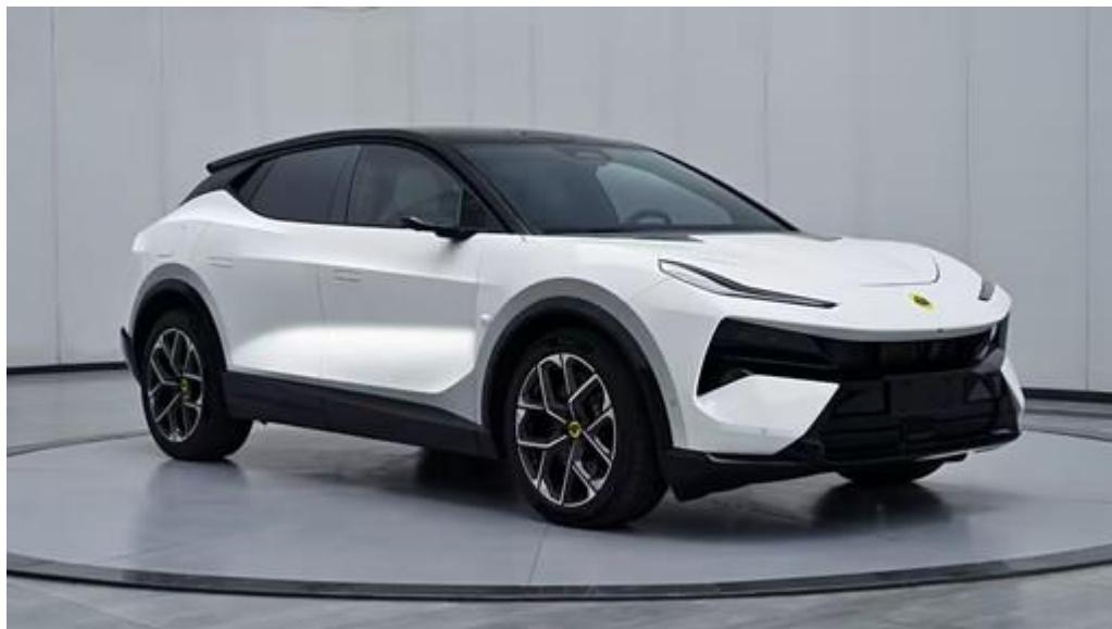
Внешне For Me практически не отличается от Eletre, габариты остались прежними: 5103 мм в длину, 2019 мм в ширину и 1636 мм в высоту, колесная база — 3019 мм. Снаряженная масса — до 3080 кг.
