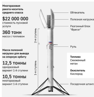
Ракета на метановых двигателях «Амур». Концептуальная модель
