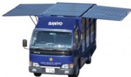
Модель оснащена **солнечными панелями**, разработанными самой Sanyo и литий-ионными батареями, позволяющими грузовику проехать без подзарядки до 130 км. Правда, на сам процесс зарядки от солнца уйдет 16 часов, а от электросети – 8.
