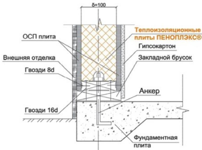
Схема 2. Пример конструкции каркасной стены.
