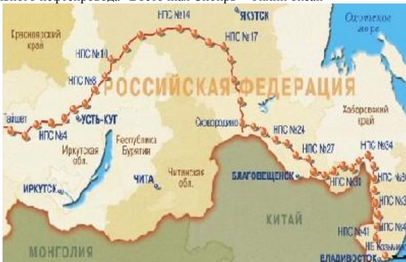
Строительство участка ГНПС "Тайшет" -НПС "Сковородино" (ВСТО-1) магистрального нефтепровода Восточная Сибирь - Тихий Океан мощностью до 30 млн. тонн нефти в год и протяженностью 2694 км со строительством 7 НПС, нефтеналивного порта в бухте "Козьмино" начато в 2006 г. В 2009 г. объекты введены в эксплуатацию.
