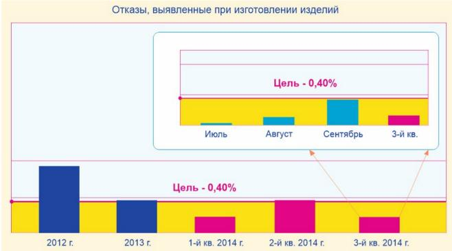
2. Отказы изделий, выявленные при их эксплуатации у Потребителя Процент возвратов изделий от Потребителя в 3-м кв. 2014 г. превысил целевой показатель. Ухудшение произошло из-за возврата в сентябре счетчиков МИР С-03 (2011 года выпуска). Причина: выход из строя батарейки LS14250CNA.
