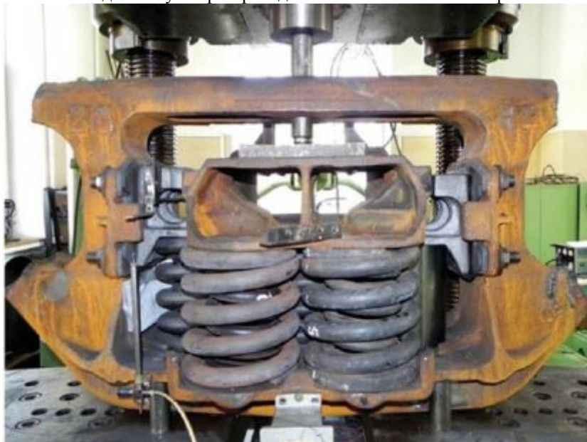
Рис. 3. Испытание фрикционных клиньев
