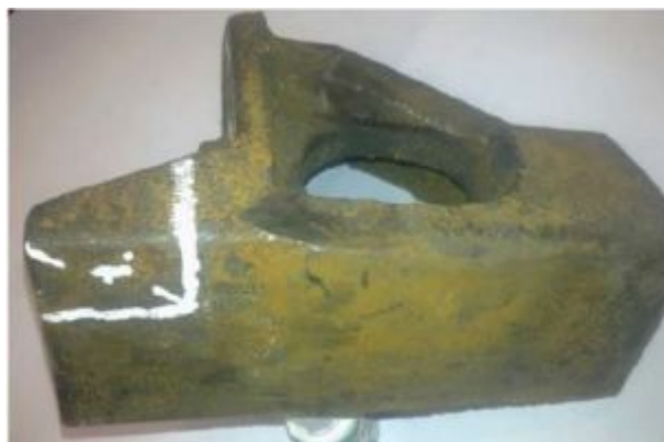
Рис. 1. Схема вырезки образцов для исследования микроструктуры
