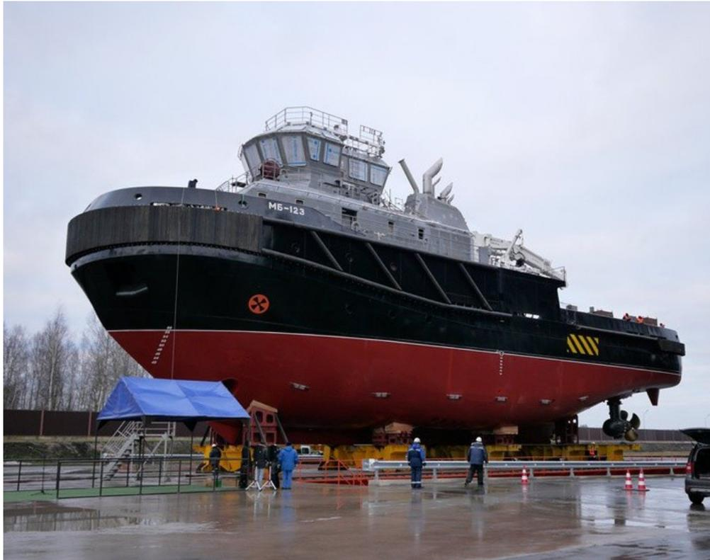
Основные технические параметры: длина наибольшая – 48 м, ширина наибольшая – 13 м, осадка – 5,4 м, скорость – 14,5 узлов, сила тяги на гаке – 80 тонн, водоизмещение – 1216 тонн, мощность - 2x2666 КВт.
